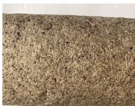
Fig. 6, 7, 8 e 9 Experiências com Engaço como carga e diversos ligantes
