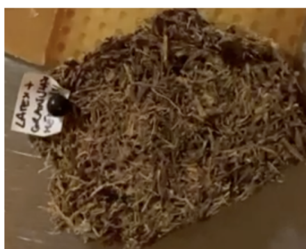
Fig. 6, 7, 8 e 9 Experiências com Engaço como carga e diversos ligantes
